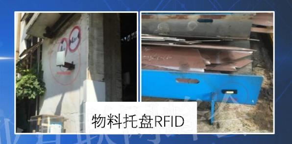
设备位置信息的实时监控和任务优化调度; 物料托盘全厂域的实时定位,生产计划自适应调整。
