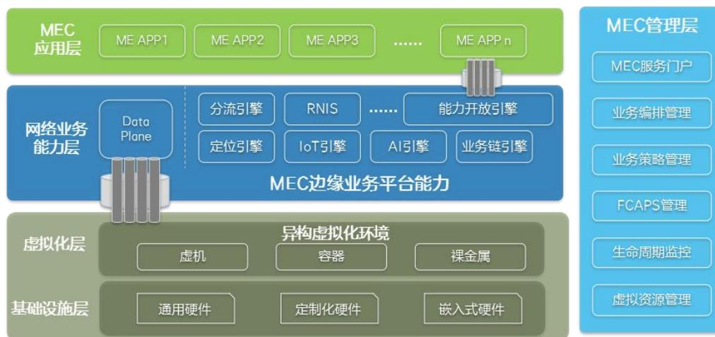
图 3-11 MEC 整体架构
