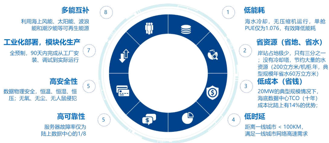
图 152 海底数据中心实施成效
