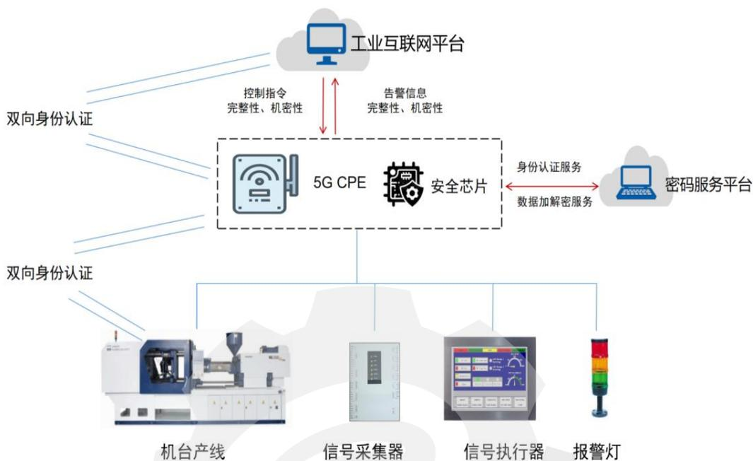
图 4.3 5G LAN 数据安全测试床总体架构
